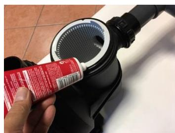
anschießen und über den Hauswasserhahn/Hauswasserleitung das Wasser zum leichteren ansaugen der Filterpumpe zuführen. („Turbo-Effekt“)
