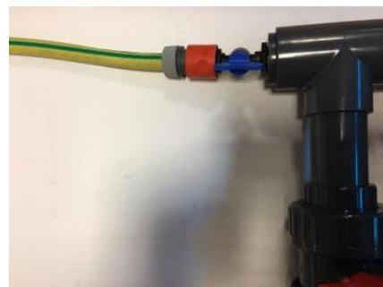
Bitte nach dem Ansaugen der Pumpe und sobald diese in den Volllastbetrieb gelangt ist, das Wasser-Leitungsnetz wieder abdrehen.
