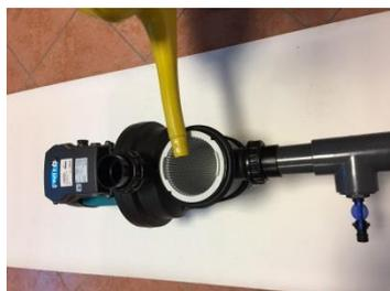
Gießen Sie nun in den geöffneten Vorfilter (durchsichtigen Kunststoffdeckel an der Filterpumpe abnehmen) Ihrer Filterpumpe z.B. mit einer Gießkanne etwa 5 Liter Frischwasser in das Vorfiltergehäuse Ihrer Filterpumpe und schließen Sie den Vorfilterdeckel (durchsichtiger Kunststoffdeckel) sorgfältig indem Sie die Dichtung oder O-Ring dieses Deckels und dessen Gewinde mit Vaseline schmieren. ?? Ist das Vorfiltersieb eingebaut!
